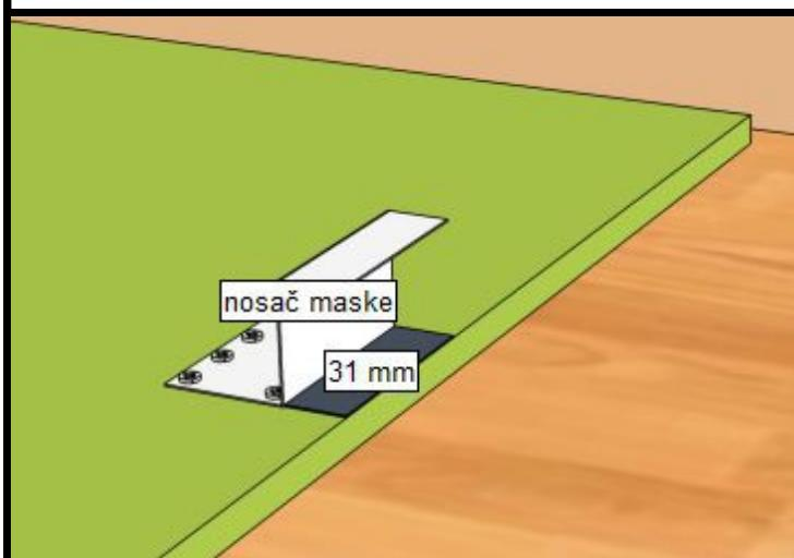
pomoću parčeta hdf-a,širine 31 mm,koje ste dobili uz nosače postavite nosače na 31 mm od donje ivice maske a zatim zašrafite kao na slici
