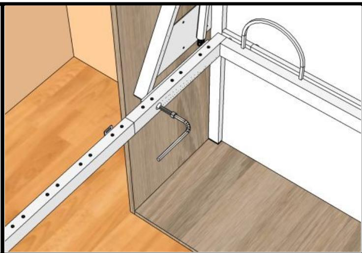
**inbus šraf M-10 provući kroz ležaj i koristeći inbus ključ 8 mm uvrnuti u čauru na nosaču kreveta i dobro stegnuti**
